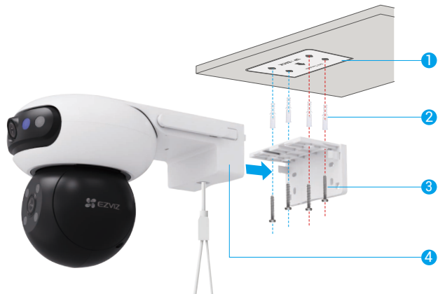
Fig. 1 Montaje en techo
